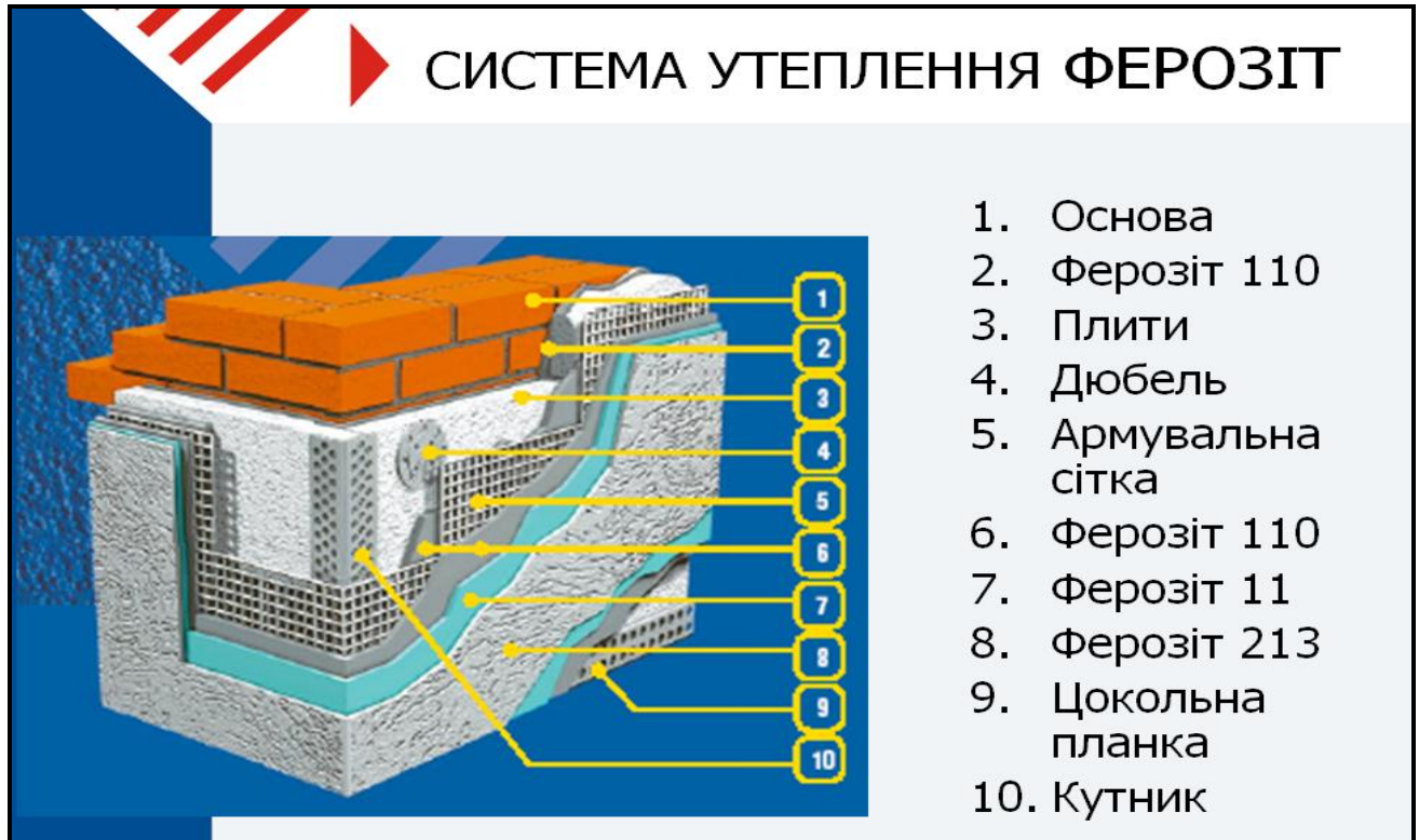
Рис. Д.1. Структура зовнішнього утеплення будівлі
