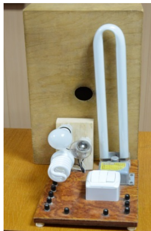
Рис. 1. Установка для дослідження характеристик електричних ламп
