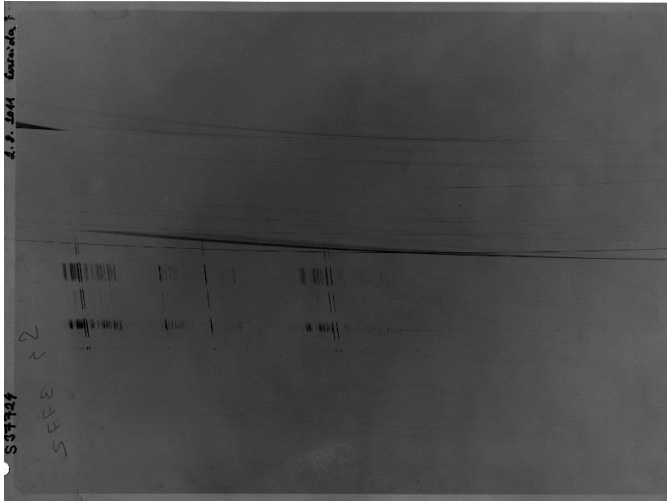
Рис.2. Спектр метеора 2-3 серпня 2011 року. Напрямок польоту – згори донизу. Спектр поділений на фрагменти за допомогою обтюратора. Ліворуч – перший спектральний порядок, праворуч – частина другого спектрального порядку. Горизонтальні смуги – зображення нульових спектральних порядків зір. У центрі знімка зоря \alpha Орн (Orphiuchus – Змієносець)
