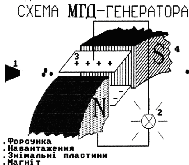
Рис. 5.25. Вигляд екрана під час моделювання схеми МГД-генератора.
