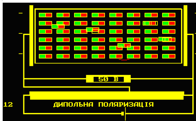
Рис. 5.25. Демонстрація за допомогою комп'ютера дипольної поляризації.
