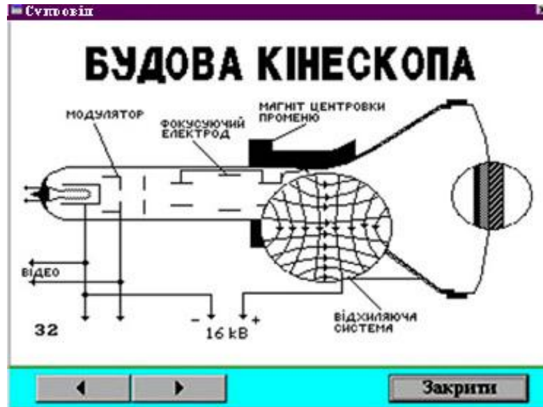
Рис. 5.21. Зображення останнього слайду цілого ланцюга мультимедійних відображень будови та принципу дії електронно-променевої трубки.
