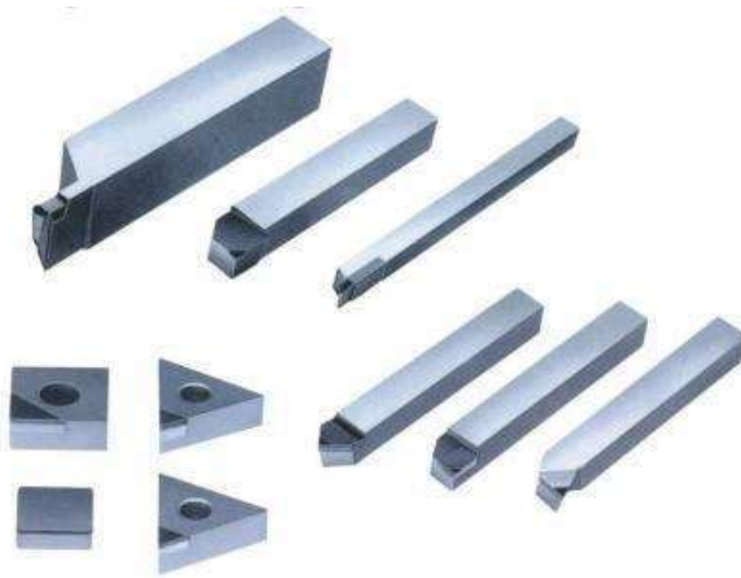
Рис. 5. Різальний інструмент зі штучних алмазів та КНБ
