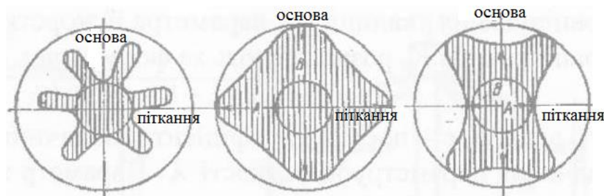
Рис. 4.3. Проекції тканин з різним ступенем драпірування: а – добре; б – погане; в – погане по основі
