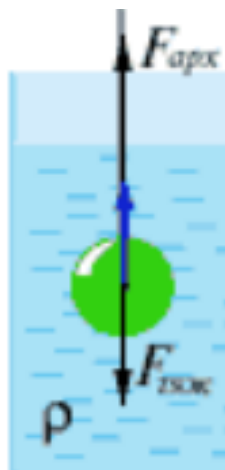
Рис. 4.8. Візуалізація сил під час з'ясування умов плавання тіл
