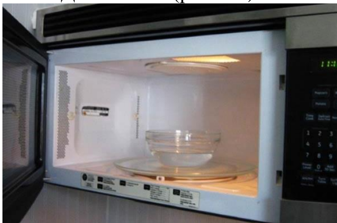
Рис. 3.4. Дослід для визначення корисної потужності та ККД мікрохвильової печі.
