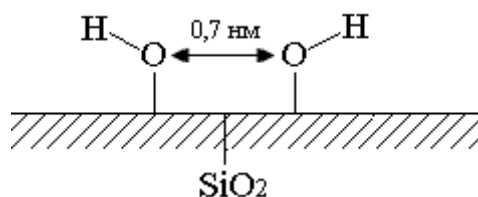
Рис. 3.6. Поверхня гідратованих аеросилів з ізольованими силанольними групами
