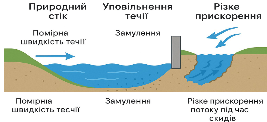
Рис. 2.3 Профіль змін гідрологічного режиму річки внаслідок будівництва ГЕС (авторська схема)
