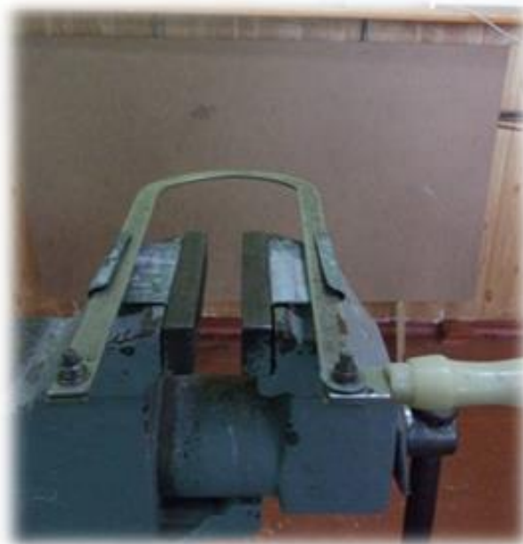
Рис. 3. Доопрацювання слюсарних лещат для стиснення рамки лобзика
