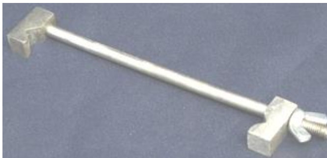
Рис. 5. Варіанти виконання скоб для стиснення рамки лобзика
