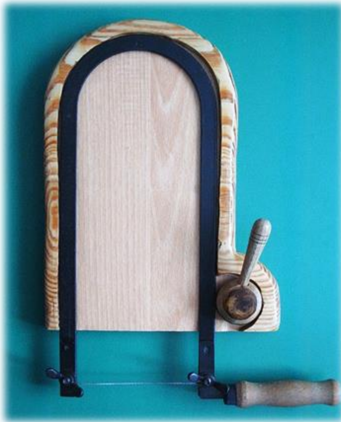
Рис. 4. Ексцентрикові зажими рамки лобзика
