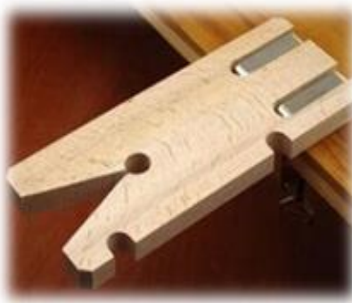
Рис. 2. Столики для випилювання оснащені пристосуванням для стиснення рамки лобзика
