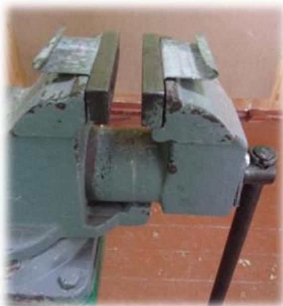
Рис. 3. Доопрацювання слюсарних лещат для стиснення рамки лобзика
