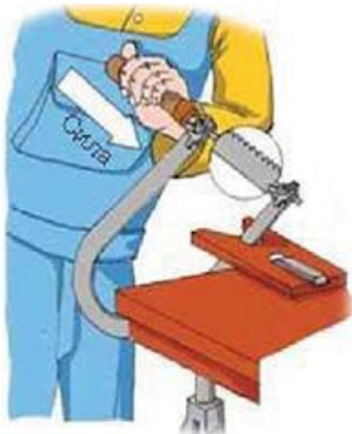
Рис. 1.а. Способи стиснення рамки лобзика
