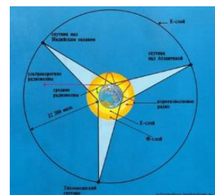
Рис. 10. Схема розміщення супутників на геостаціонарній орбіті
