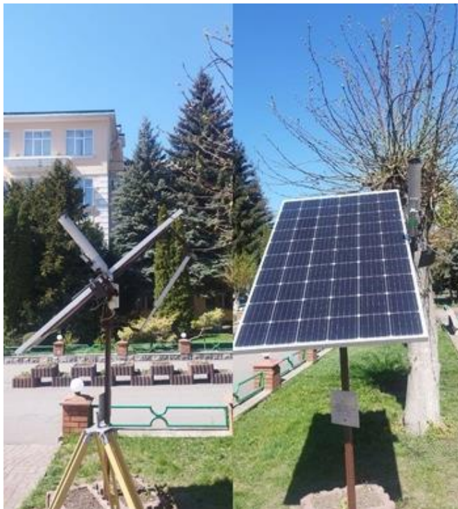
Рис. 2.4. Зображення двохосової міні електростанції з підключеним телескопом
