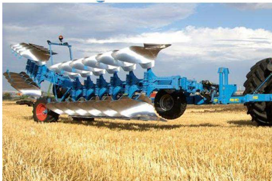
Рис. 13. Оборотний плуг для гладкої оранки
