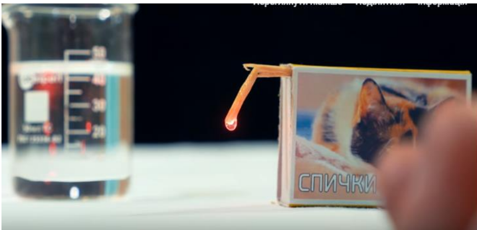
Рис. 4. Спрямовуємо промінь лазерної указки на краплю води.
