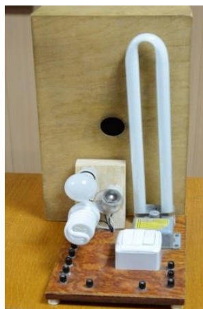
Рис. 1. Установка для дослідження характеристик електричних ламп
