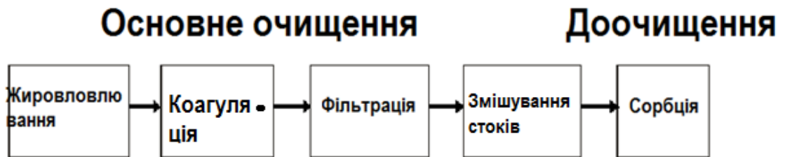
Рисунок 3.4– Удосконалена технологічна схема очищення стічних вод виробництва кисломолочного сиру та вершкового масла
