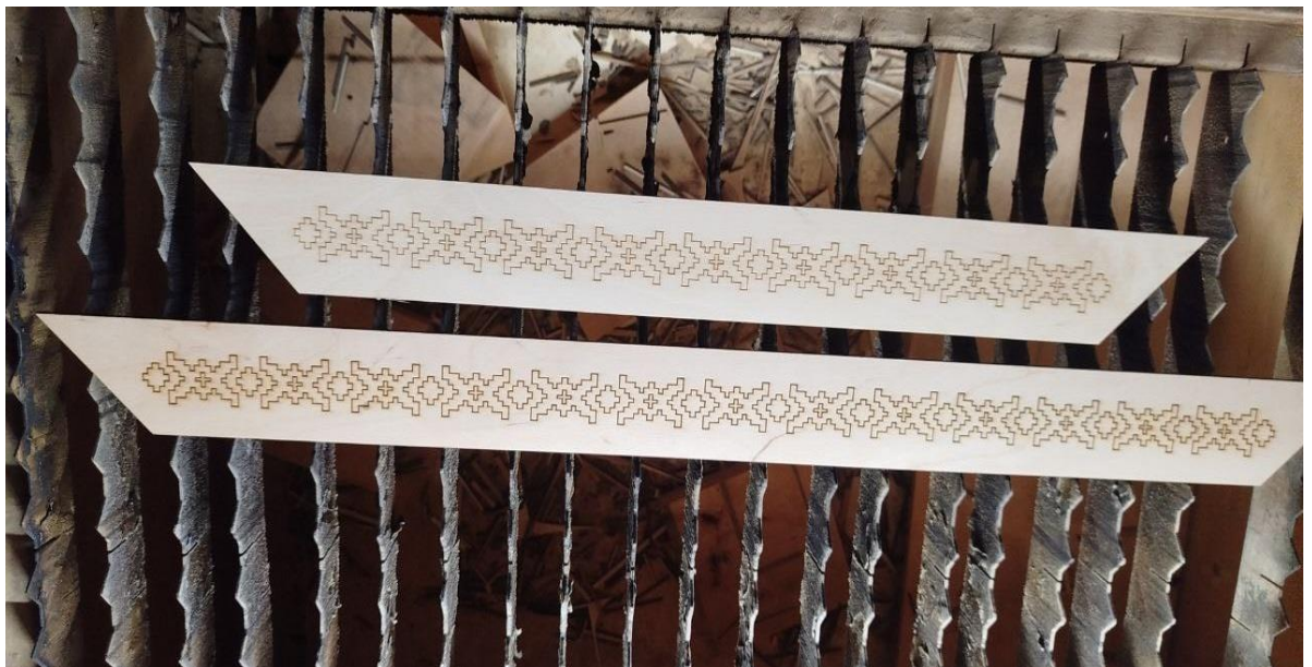
Рис. 3.9 Вирізані і гравійовані деталі рамок на лазерному верстаті
