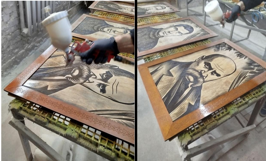
Рис. 3.15 Лакування серії портретів з використанням фарбопультоту та компресора
