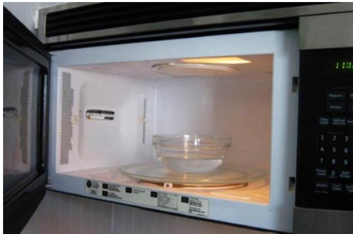
Рис. 2.4. Дослід для визначення корисної потужності та ККД мікрохвильової печі.
