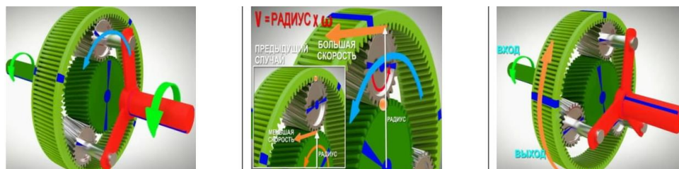
Рис. 2. Режимы работы планетарного механізму у напрямі зліва направо: нерухоме корончасте колесо; нерухоме сонячне колесо; нерухоме водило [7]
