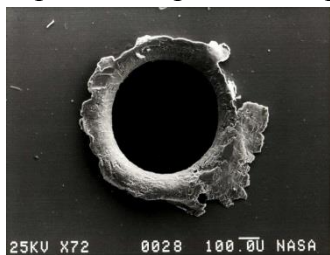
Рис. 8. Пробоїна в панелі супутника SolarMax (NASA), утворена в результаті зіткнення осколком космічного сміття
