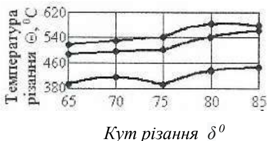
Рис. 4.6. Залежність температури різання від кута \alpha різання при різних швидкостях.
