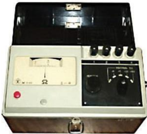
Рис. 3.2. Вимірювач опору заземлення М416
