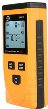
Рис. 5.1. Загальний вигляд тестера електромагнітного випромінювання BENETECH GM3120 (верхні покази напруженість електричного поля 0 В/м, нижні покази напруженість магнітного поля 0,18 мкТ):
