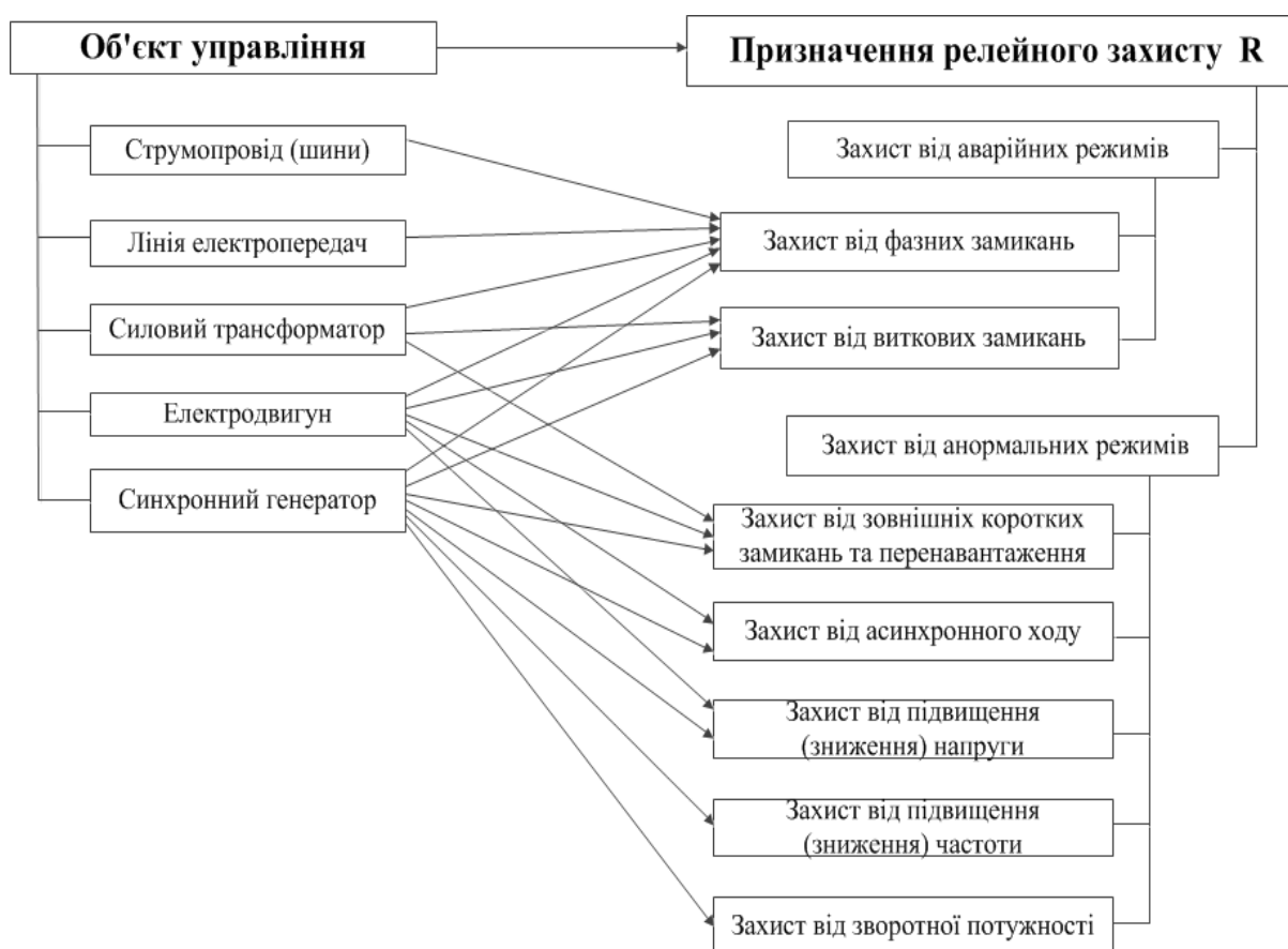
Рис. 4. Причинно-наслідковий зв'язок, що конкретизує призначення релейного захисту для кожного об'єкта енергосистеми
