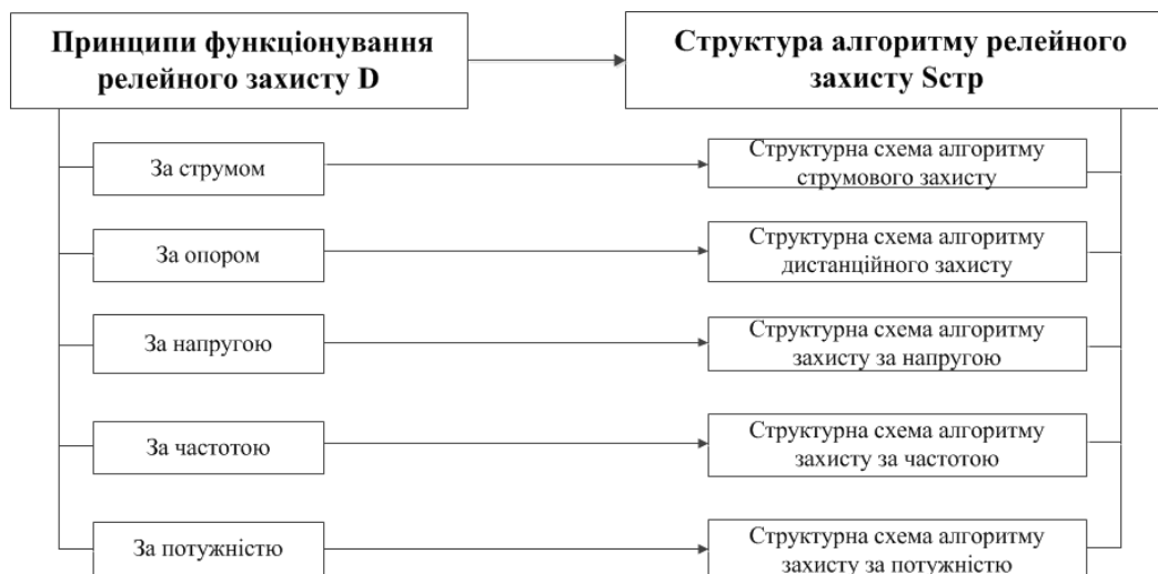
Рис. 6. Причинно-наслідковий зв'язок між принципом функціонування та структурою алгоритмічного забезпечення релейного захисту
