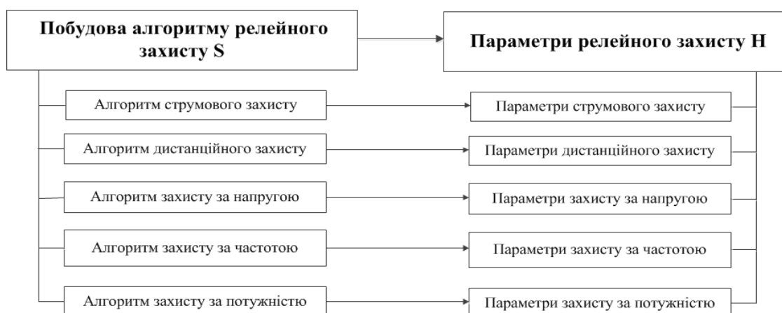
Рис. 7. Причинно-наслідковий зв'язок між змістом алгоритму захисту та параметрами налаштування захисту
