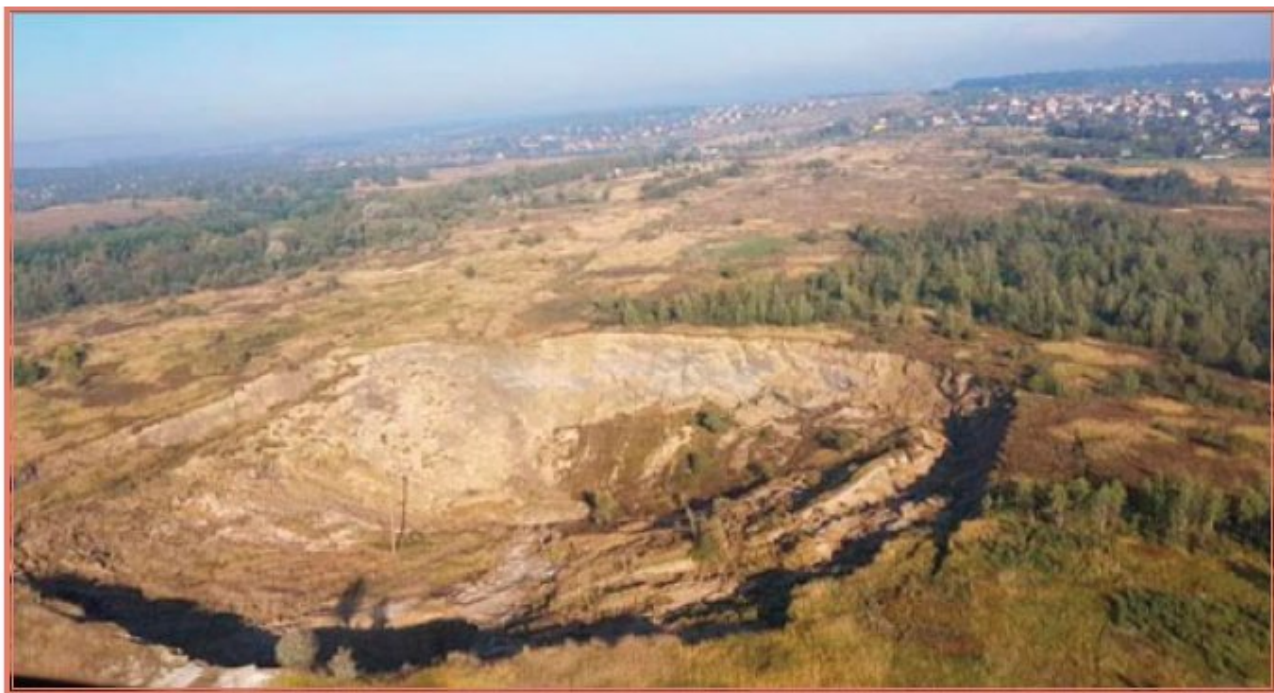
Рис. 2.5. Карстовий провал на території гірничого відводу рудника №2 «Полімінералу» (м. Стебник) [24]
