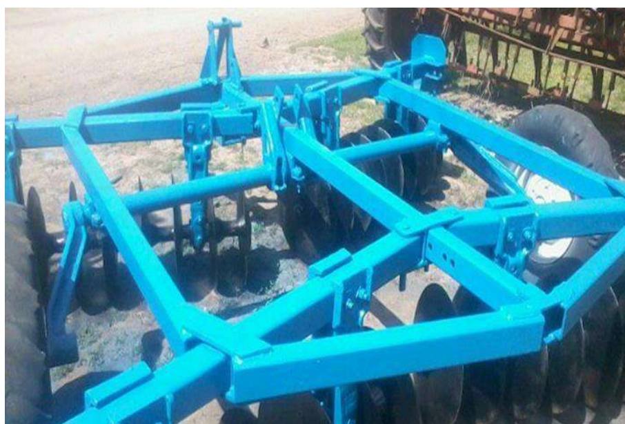
Рис. 4. Механізм підйому борони БГГ-3, укомплектованої сферичними дисками
