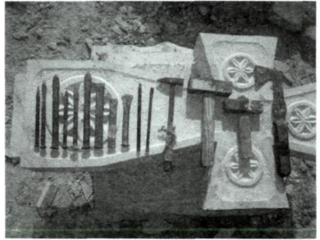
Рис. 44. Інструменти каменяра: шпунти (6 шт.), шкарпелі (5 шт.), молоточок, бучарда – велика і мала, «насека»
