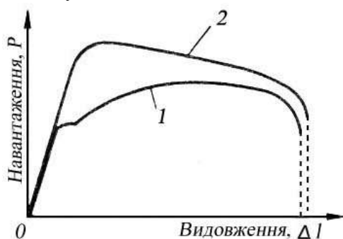
Рис. 5.1. Діаграма розтягу однієї і тієї ж сталі при статичному (1) і динамічному (2) навантаженні (розтягу)
