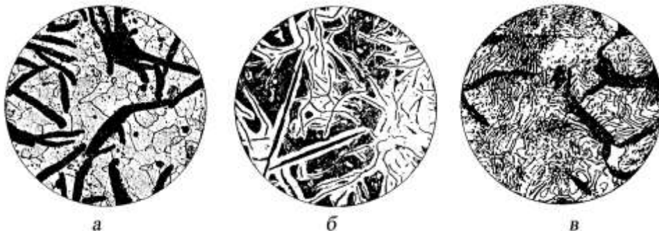
Рис. 13.6. Структури сірого чавуну з феритною (а), ферито-перлітною (б) і перлітною (в) основами, \times 200
