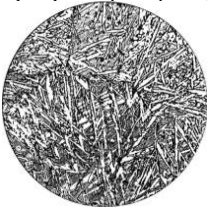
Рис. 16.2. Мікроструктура мартенситу, \times 1000
