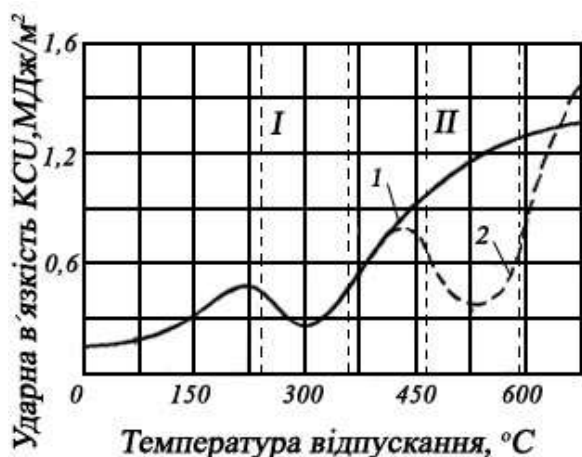
Рис. 21.1. Залежність ударної в'язкості конструкційної сталі від температури відпускання: 1 – швидке охолодження, 2 – повільне охолодження
