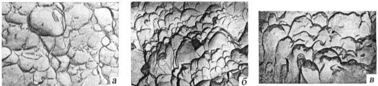
Рис. 2.3. Ямки: а – рівновісні ямки, що спостерігаються при розтягу вздовж осі (ПЕМ. X 1200); б – витягнуті ямки, що спостерігаються при розклинюючому відриві (злам, “розщеплення”); в – ямки неправильної форми, що спостерігаються при зародженні мікропор на джерелах руйнування, які мають протяжні геометричні розміри (ПЕМ. X1200)
