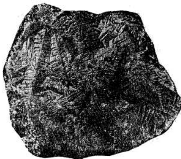
Рис. 1.4. Зливок сурми; кристалізація у вигляді дендритів. \times 1/4
