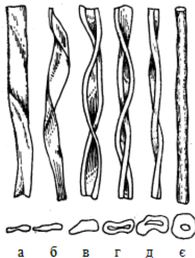
Рис. С.2. Будова бавовняного волокна: а – незрілого; б,в – недоспілого; г,д – зрілого; є – переспілого
