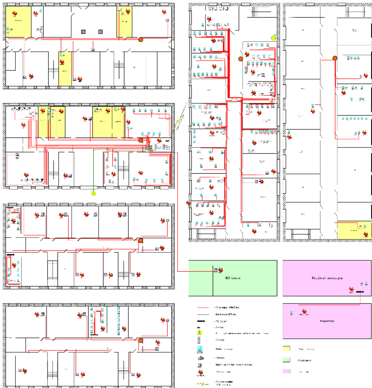
Рис. Е.1. Схема локальної мережі ДПТНЗ ВМ ВПУ
