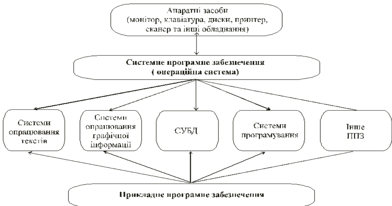
Рис. 2.2. Взаємозв'язок апаратного обладнання, системного та прикладного програмного забезпечення
