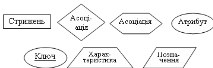
Рис. 8.6. Позначення, що використовуються в ER-діаграмах
