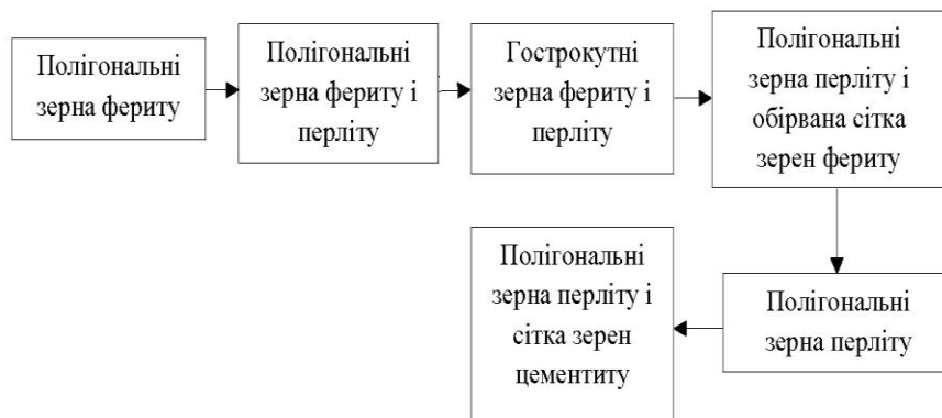
Рис. 4. Структурно-логічна схема «Перетворення форми зерен залізовуглецевих сплавів залежно від вмісту вуглецю»
