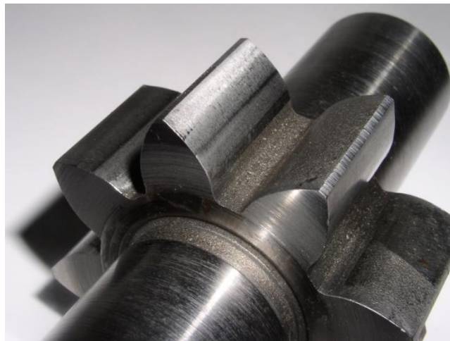
Рис. 1. Цапфи, вершини і торці зубців шестерні насоса НШ-32У зі слідами абразивного зношування
