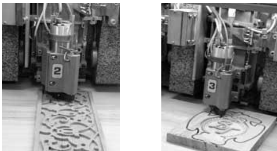
Рис.2.20. Виконання програмованими верстатами плоскорельєфного та рельєфного різьблення
