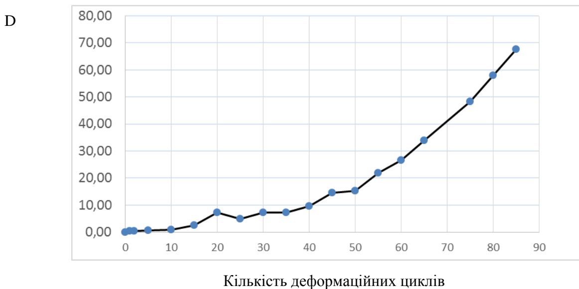
Рис. 1. Зміна пошкоджуваності біметалу алюміній-сталь при різній кількості циклів його деформування
