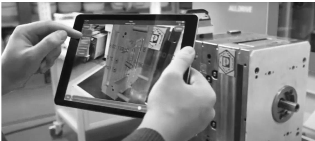
Рис. 1. Приклад налагодження обладнання з використанням AR ( https://lookinar.com/promyslovist/ )
